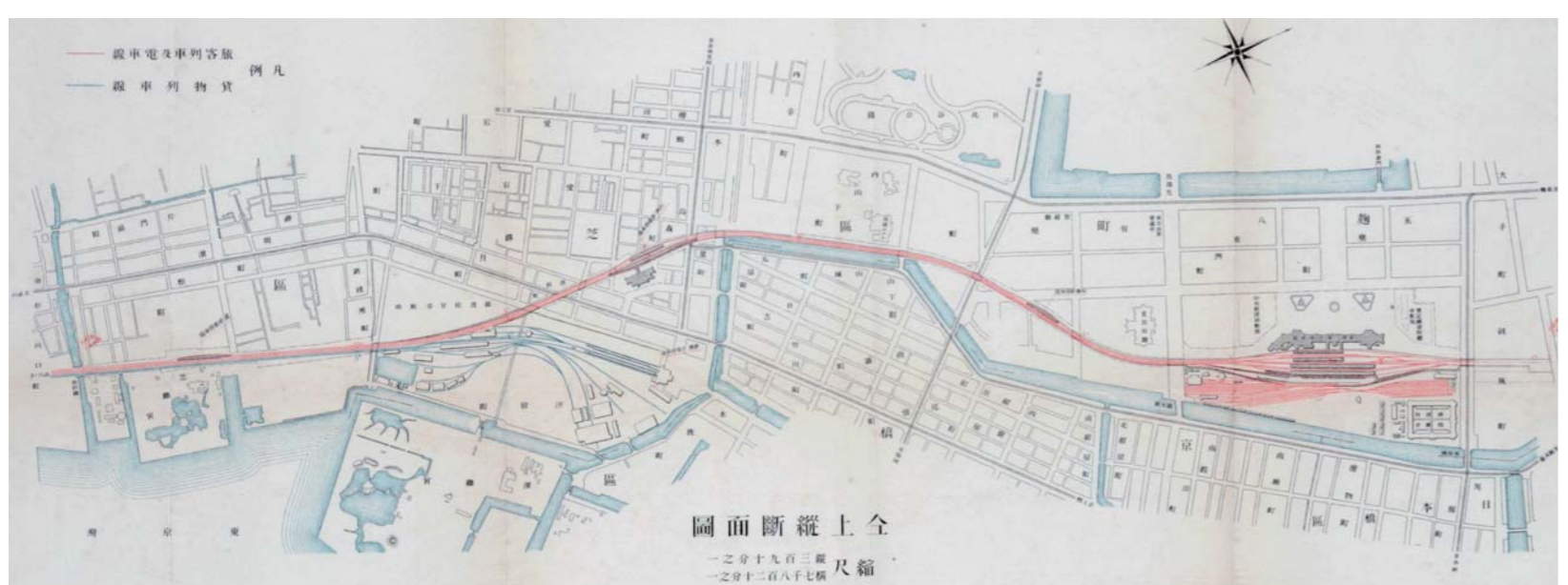
市街線金杉橋銭瓶町間線路平面図・縦断面図(部分) 『記念写真帖 大正三年十二月』1914年(大正3) 実際に施工された市街高架線の平面図。バルツァーによる路線計画がそのまま踏襲されている。中央停車場の丸の内駅舎は辰野金吾による駅舎が記入され、八重洲側の貨物設備は客車操車場などに変更されている。 Plan View and Cross Section of Urban Tracks between Kanasugibashi and Zenikamecho (Partial) Commemorative Photo Album, December 1914 The plan view of the construction of the urban elevated track. It follows the original plan by Baltzer. The Marunouchi Station building of the Central Terminal designed by Kingo Tatsuno is drawn in and the original freight facilities on the Yaesu side have been changed into a yard for passenger cars.
