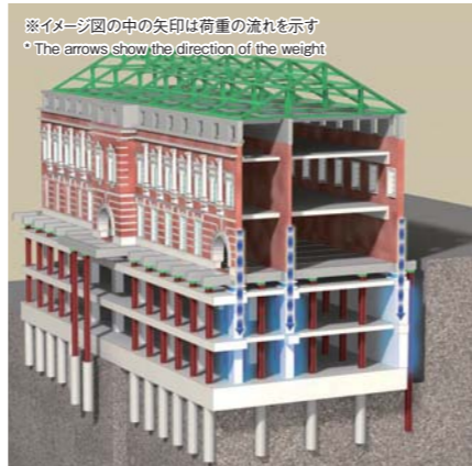
僅か70cmほどの厳しい作業環境のもと免震化が行われました Seismic base isolation work carried out in a daunting work environment only 70 cm (27.6 in) wide
