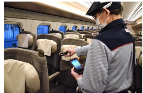
サーモグラフィを活用して座席濡れ確認をしている様子
