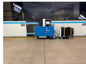
ホームドア自動洗浄ロボット
